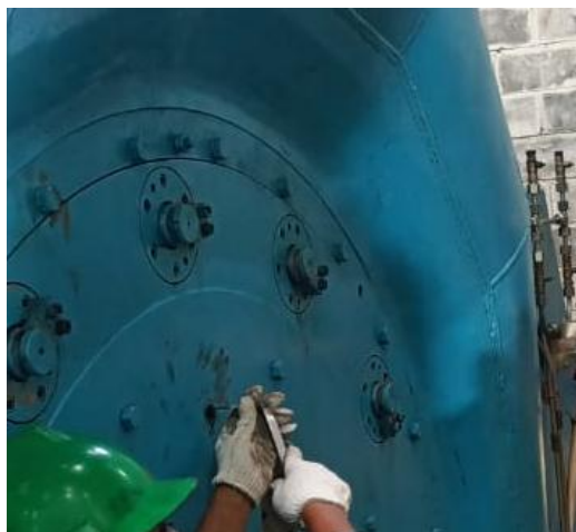
Gambar 6 Bagian pengukuran runner dengan crown seal
