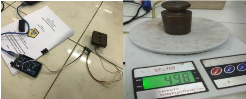
Gambar 3.15 Pengujian Sensor Load Cell (a) dan Timbangan Manual (b).
