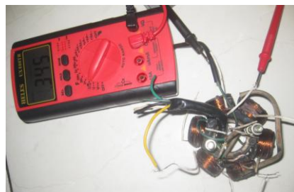
Gambar 5.6 Pengujian Lilitan Kumparan Magnet Motor Revo
