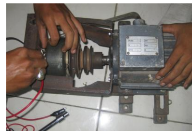
Gambar 5.6 Pengujian Lilitan Kumparan Magnet Motor Revo
