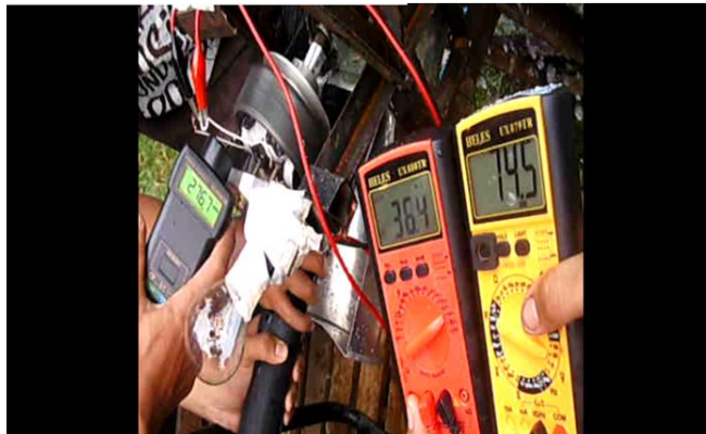
Gambar 5.9 Tegangan yang Dihasilkan oleh Prototipe Mini Screw turbin dan Generator
