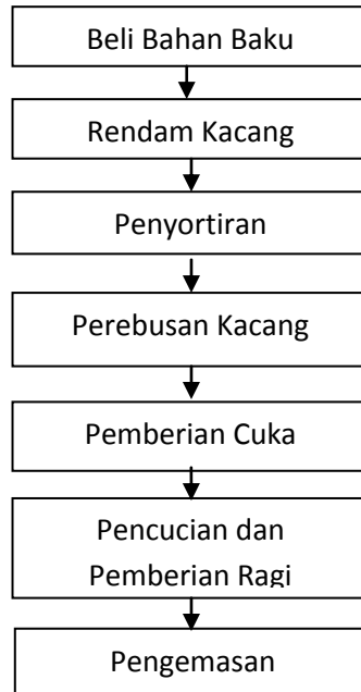
Gambar 4.1 Proses Produksi Tempe (Hasil Penelitian, 2014)
