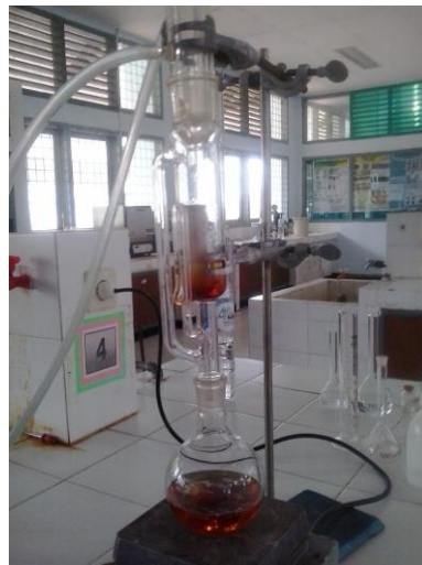
Gambar 10. Ekstraksi oleoresin jahe merah dengan metode sokletasi
