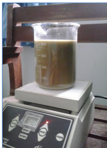
Gambar 9. Ekstraksi oleoresin jahe merah menggunakan metode digesti
