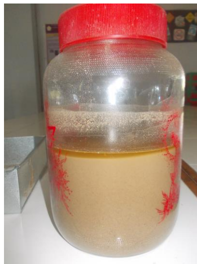
Gambar 8. Ekstraksi oleoresin jahe merah dengan metode maserasi dengan pengadukan
