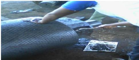
**Gambar 4.4** Proses pelepasan rumah *bearing*
