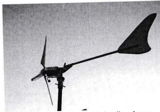
Gambar 4. Kincir angin skala mikro dengan mekanisme *furling control*.
