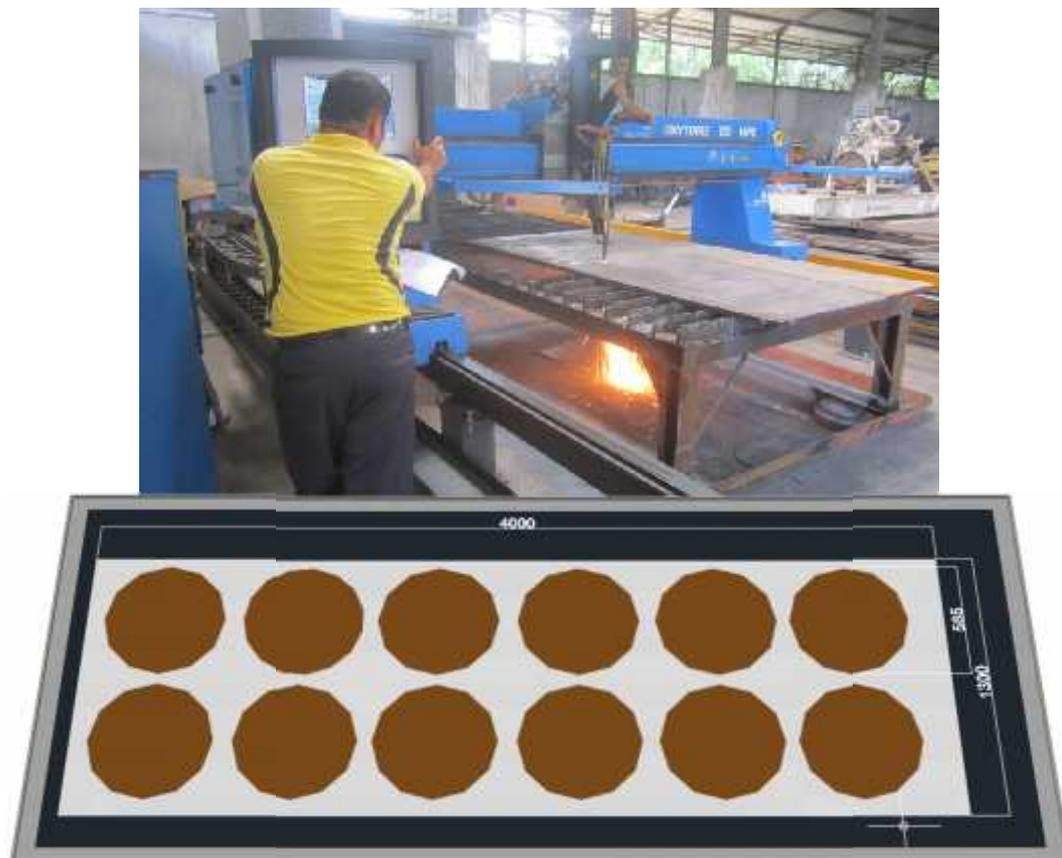
**Gambar 4.6 Skema Ukuran Pelat Yang Akan Dipotong**
