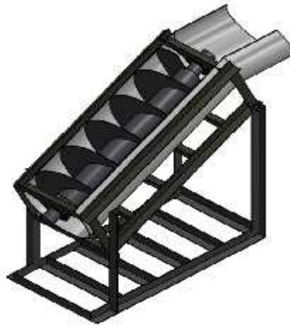
**Gambar 4.1 Designe *Screw* Turbin PLTMH Yang Menggunakan 5 Lempengan Blade (Pitch)**
