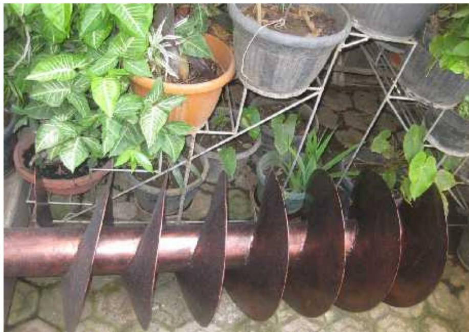
**Gambar 4.15 Hasil Pengelasan Lempengan Blade**
