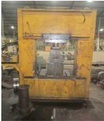
**Gambar 4.9 Mesin Jack Untuk Menarik Lempengan Pelat**
