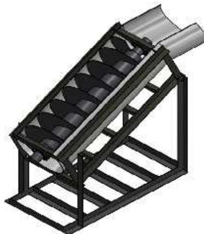
**Gambar 4.1 Designe *Screw* Turbin PLTMH Yang Menggunakan 7 Lempengan Blade (Pitch)**
