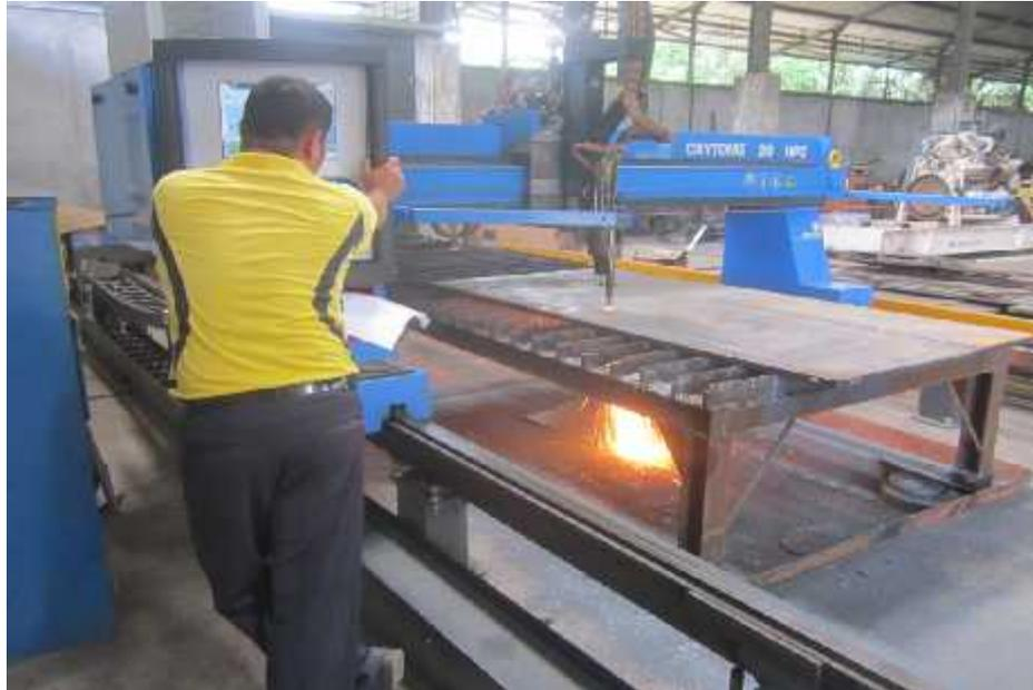
**Gambar 4.7 Proses Pemotongan Pelat Dengan Mesin Las Oxy**
