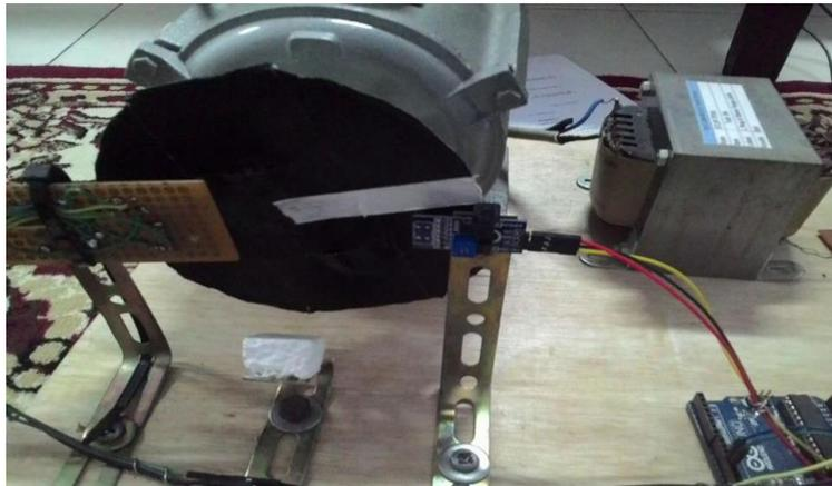
7. Foto pengujian *steady state* berbeban pada kecepatan 2500 Rpm
