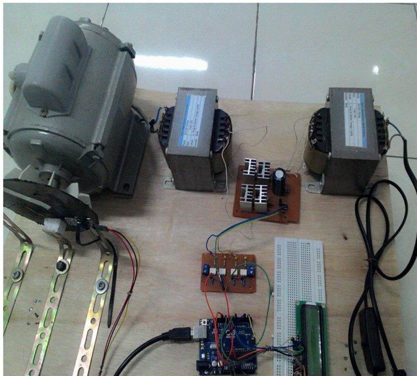
Gambar 4.1 Hasil perancangan alat pengatur kecepatan motor induksi
