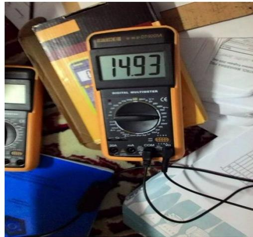
Tegangan keluaran yang telah di filter digunakan sebagai sumber MOSFET + dan untuk sumber MOSFET – menggunakan sumber CT pada trafo. Tegangan keluaran dari MOSFET yang terukur yaitu:
