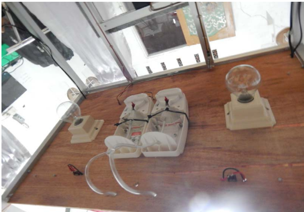
Gambar 8. Aktuator Sprayer Air, Pupuk, dan Lampu
