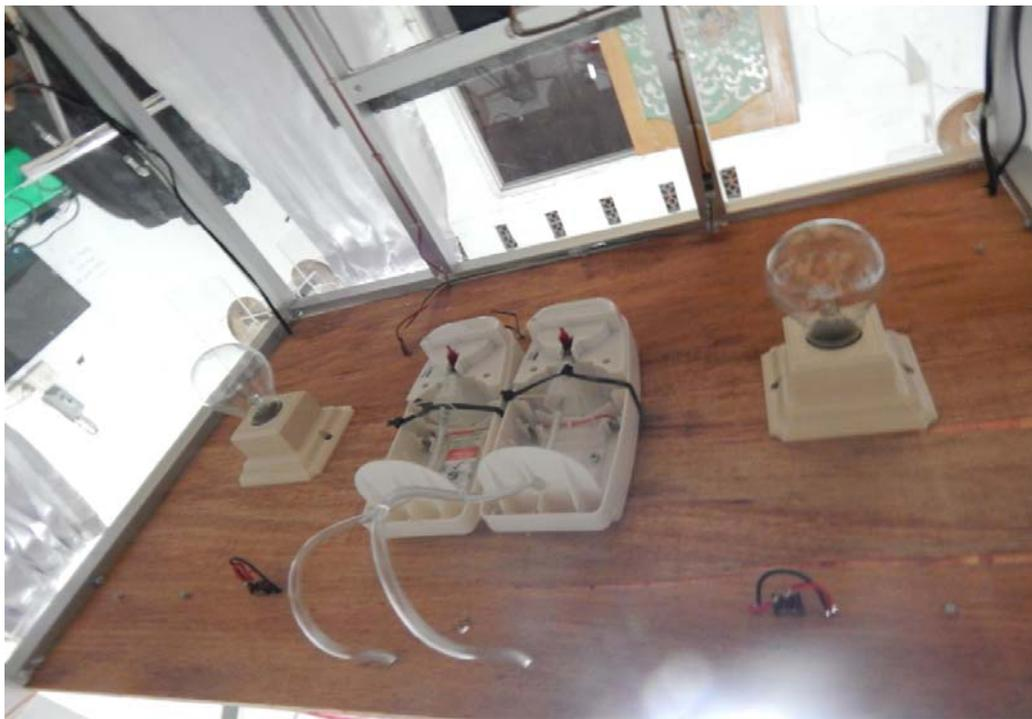
Gambar 8. Aktuator Sprayer Air, Pupuk, dan Lampu
