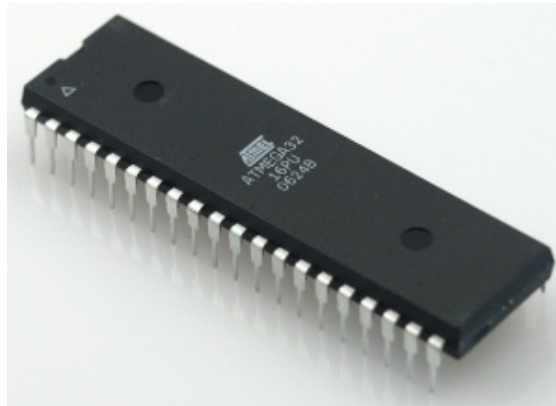
Gambar 2.8. Bentuk Fisik Mikrokontroler ATmega32 (Sumber: Datasheet ATmega32)
