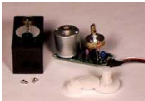
Gambar 2.16. Sistem Mekanik Motor Servo
