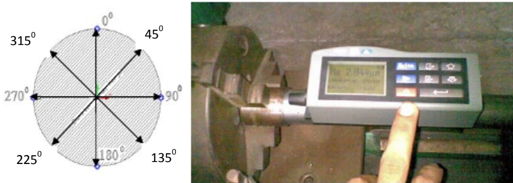
Gambar 3.10 Pengukuran kekasaran dengan Roughness tester TR200
