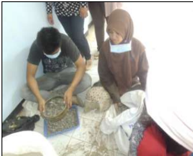
Gambar 4.1 Proses Penyaringan Agregat
