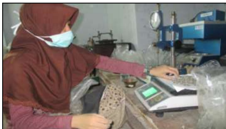
Penimbangan Agregat Sesuai Gradasi
