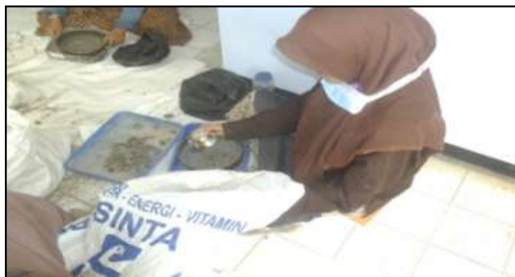
Penyaringan Agregat Sesuai Gradasi
