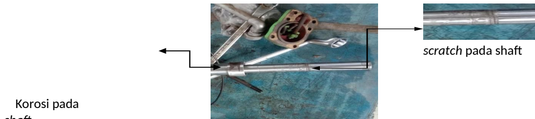
Gambar 5 Kerusakan Pada Shaft/Poros
