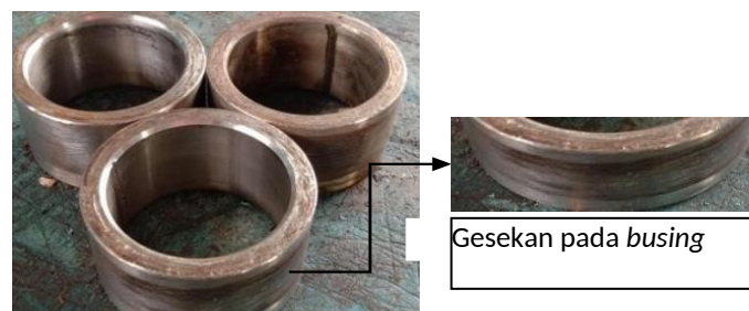
Gambar 6. Kerusakan Pada Busing
