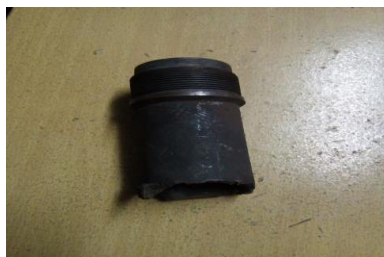
Gambar 8. Kerusakan nosel RCB
