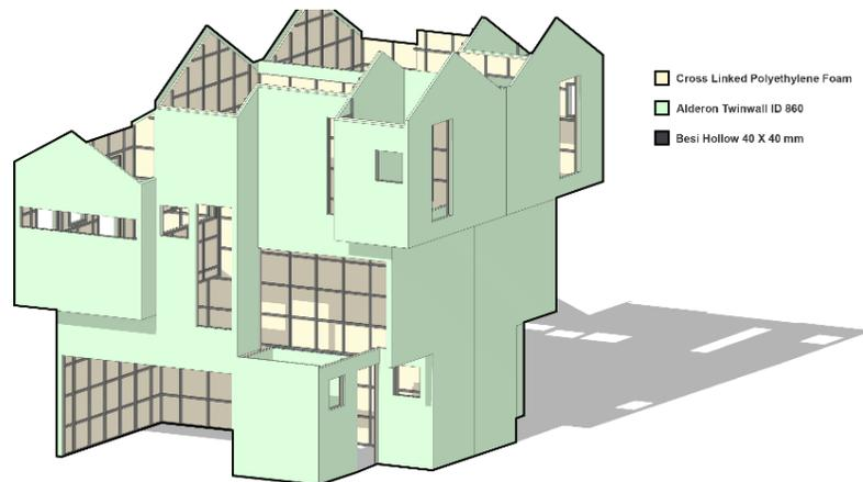
Gambar V. 81. Sistem Struktur Dinding
