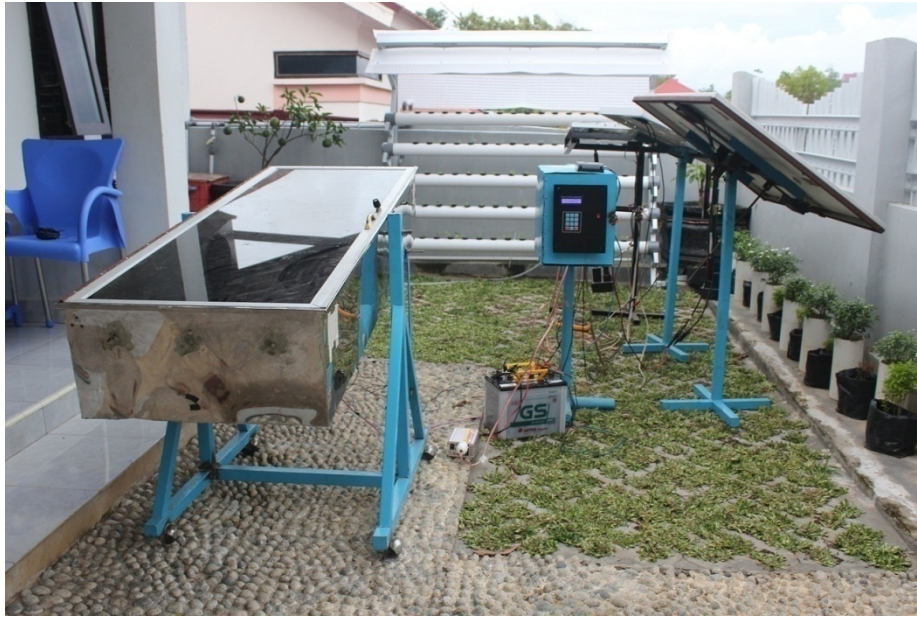
Gambar 4. Tampak keseluruhan sistem mesin pengering ikan
