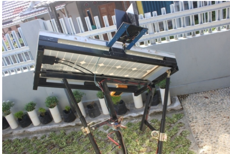
Gambar 4.1 Hasil rangka penjejak matahari dengan alat pendukung
