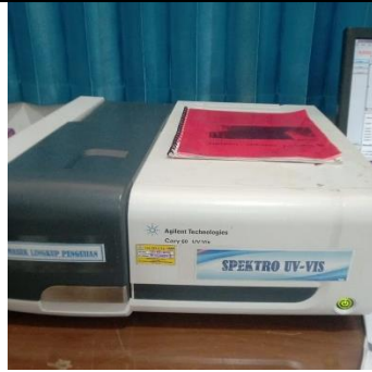
Pengujian kekeruhan menggunakan alat Spektrofotometer UV-Vis
