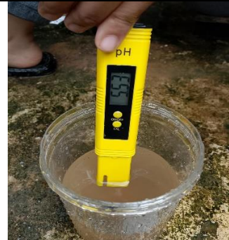
Proses pengukuran pH pada sampel air
