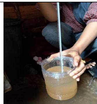
Proses pengukuran suhu pada sampel air
