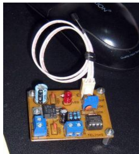
Gambar 7. Modul sensor temperatur LM35
