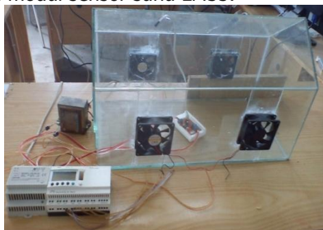
Gambar 11. Zelio SR3B261BD dan modul sensor suhu LM35
