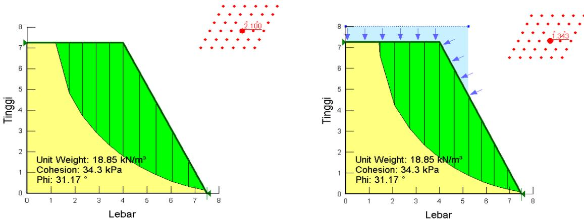
**Gambar 5.** Kondisi Kestabilan Lereng I pada Kondisi Normal dan Kondisi Banjir
