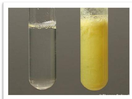
Gambar 12 . Uji positif protein pada uji xantoproteat
