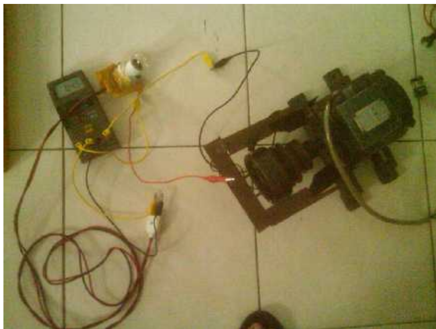
Gambar 6. Pengujian tegangan keluaran generator fluks radial berbeban 1 lampu pijar 5 watt.
