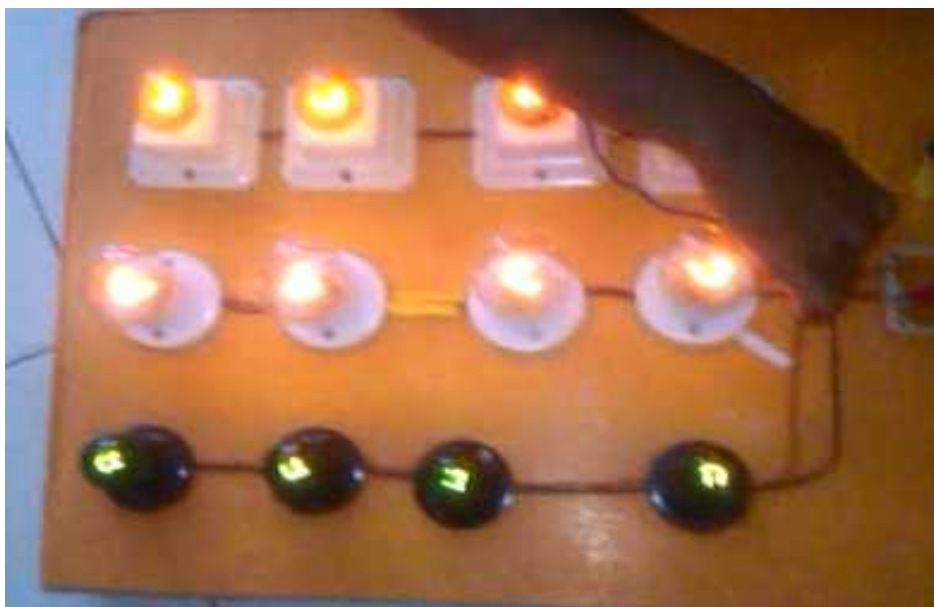
Gambar 8. Pengujian tegangan keluaran generator fluks radial satu fasa berbeban 12 lampu pijar 5 watt
