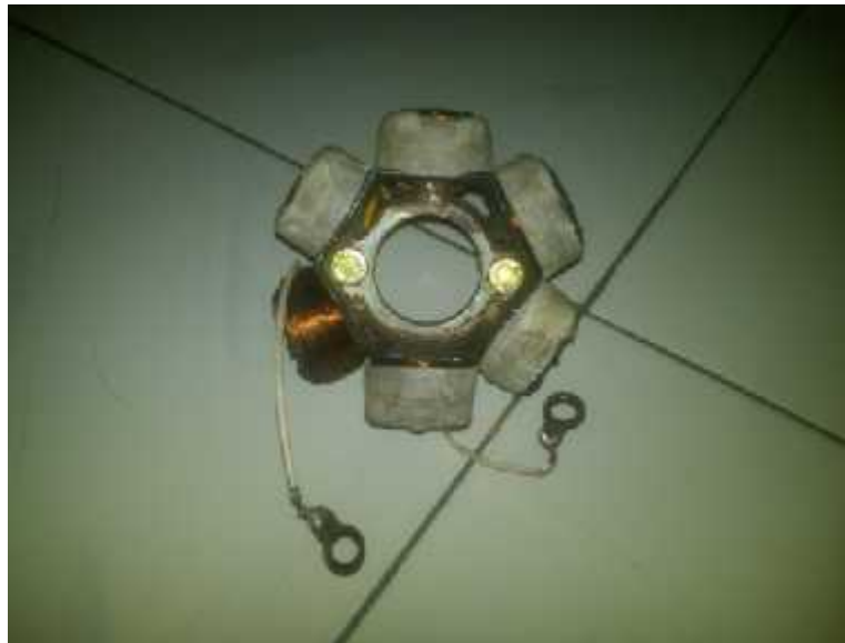
Gambar 1. Stator generator fluks radial satu fasa diameter kawat 0,15 mm
