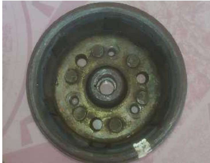
Gambar 3. Rotor generator fluks radial satu fasa
