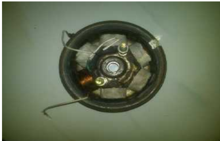
Gambar 4. Generator fluks radial satu fasa
