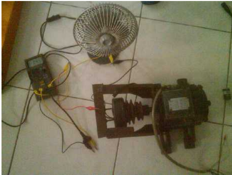
Gambar 7. Pengujian tegangan keluaran generator fluks radial berbeban kipas angin 18 watt.
