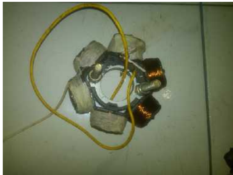
Gambar 2. Stator generator fluks radial satu fasa diameter kawat 0,25 mm
