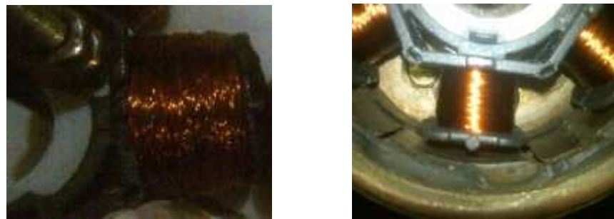
a. kumparan stator dengan kawat 0,25 mm b. kumparan stator dengan kawat 0,15 mm Gambar 4.1 Stator dan ukuran kawat yang digunakan generator fluks radial
