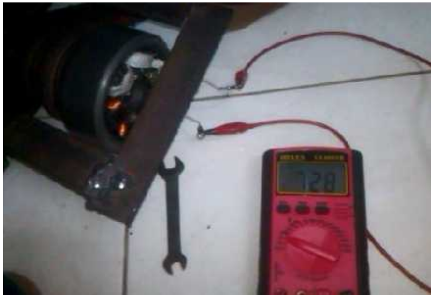
Gambar 5. Pengujian tegangan keluaran generator fluks radial satu beban nol
