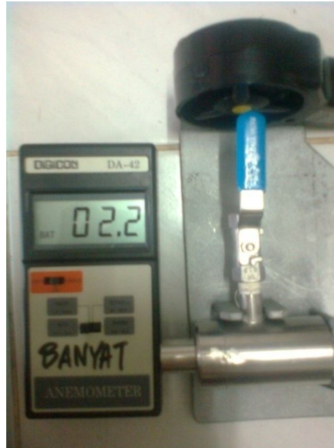
Gambar 3.15 Pengukuran kecepatan udara pada hot end.
