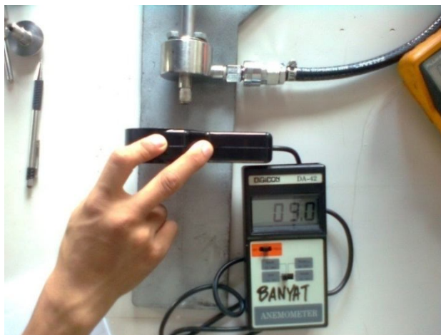
Gambar 3.14. Pengukuran kecepatan udara pada cold end
