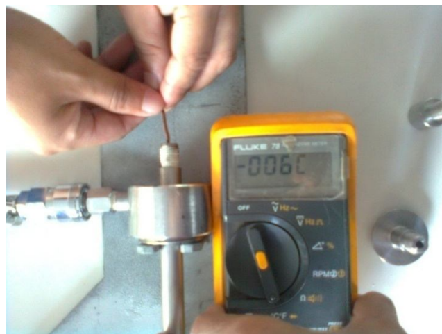
Gambar 3.12. Pengambilan data temperatur pada cold end.
