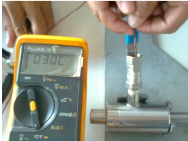
Gambar 3.13 Pengambilan data temperatur pada hot end
