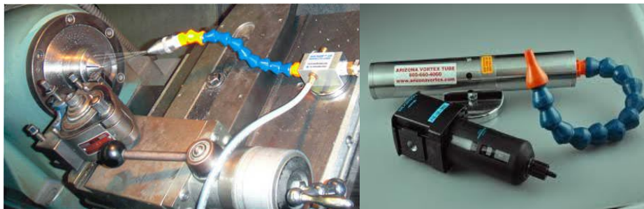
Gambar 2.4: Vorteks tube digunakan sebagai pendingin pada coolant mesin bubut. (NEX FLOW)
