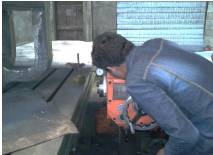
Gambar 3.9 Pengukuran Run Out Horizontal
