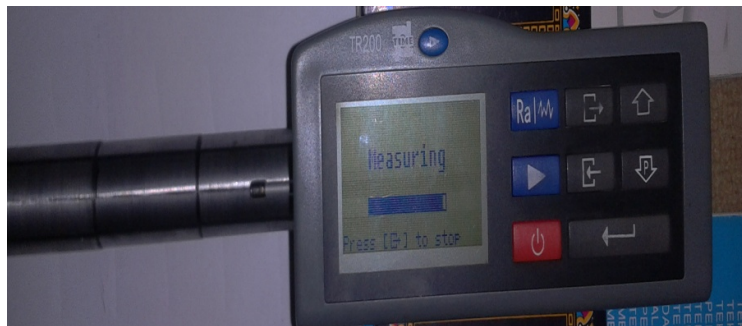
Gambar 3.16 Proses pengukuran kekasaran permukaan
