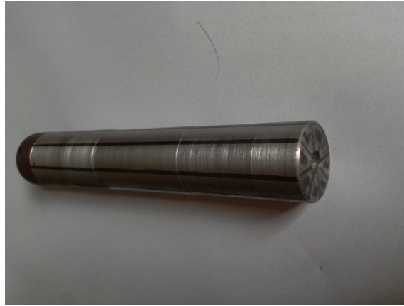
Gambar 3.13 Benda kerja kekasaran permukaan yang telah diberi tanda untuk titik-titik pengukuran
