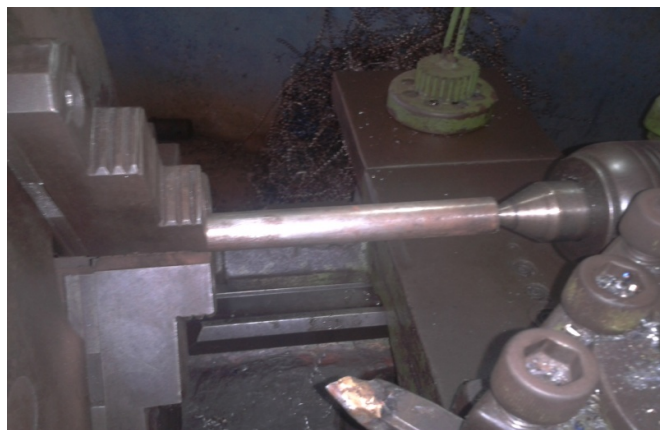
Gambar 3.10 Proses pemasangan benda kerja ke Chuck Mesin bubut
