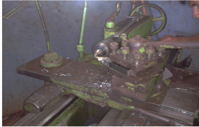
Gambar 3.11 Proses pemasangan pahat potong
