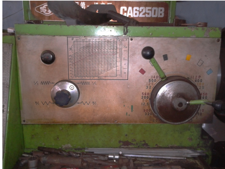
Gambar 2.8 Tuas Pengatur Kecepatan dan Plat Penunjuk Kecepatan
