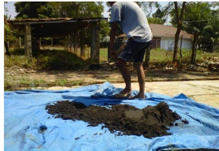
2. Pasir dibuat dalam kondisi SSD
