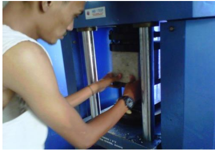
5. Peletakkan sampel pada alat uji tekan
