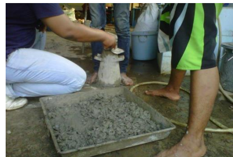
2. Pengisian adukkan kedalam cetakkan slump (1/3, 2/3 dan penuh)
