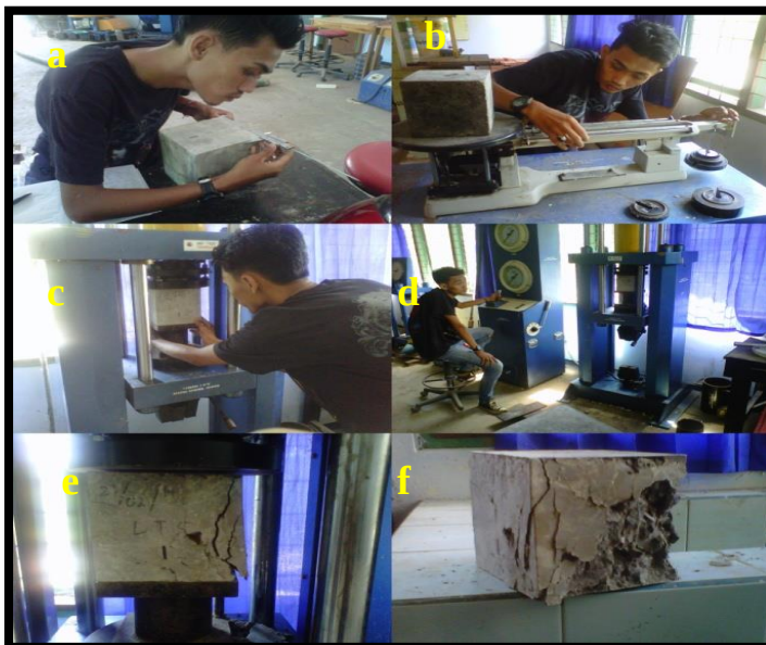
Gambar 4.13 Proses Pengujian Kuat Tekan Beton
