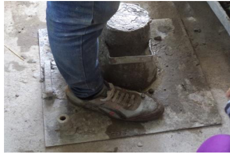
4. Perataan permukaan cetakkan slump
