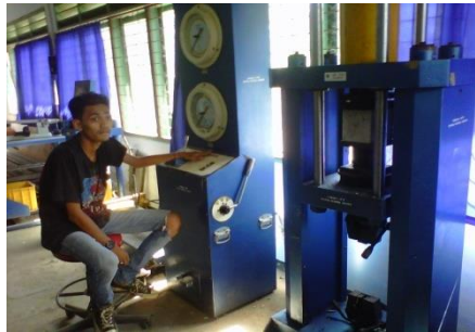
7. Pengujian sampel dengan alat uji tekan
