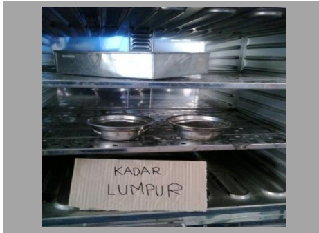
Pasir di oven selama 24 jam
