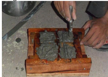
4. Penumbukkan sebanyak 32 kali pada lapisan kedua
