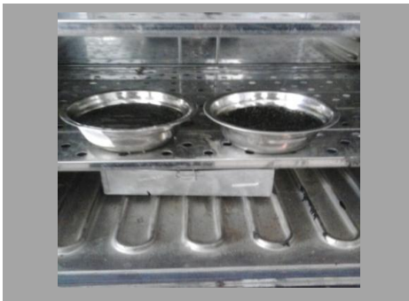
Pasir di oven selama 24 jam
