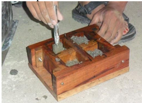
3. Penumbukkan sebanyak 32 kali pada lapisan pertama
