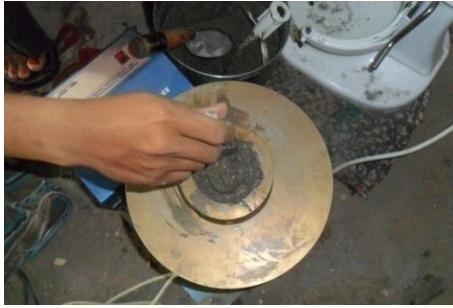
5. Penumbukkan sebanyak 20 kali pada lapisan kedua
