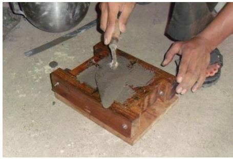
5. Perataan permukaan cetakan
