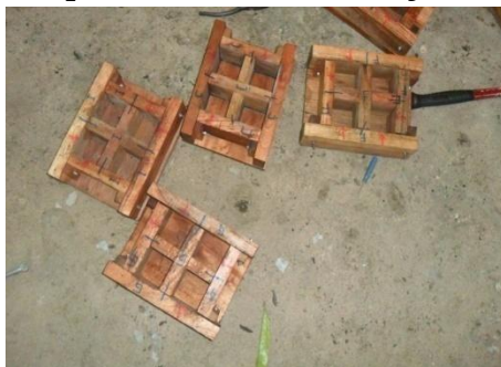
1. Persiapan cetakan kubus mortar
