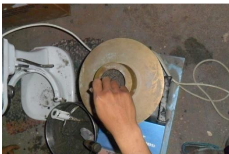
3. Penumbukkan sebanyak 20 kali pada lapisan pertama
