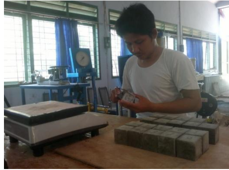
4. Pengukuran dimensi mortar
