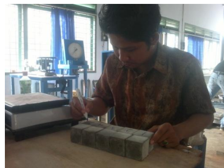
2. Kode pada mortar di perjelas
